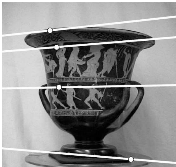
Abbildung 2.3: Rechtes Kamerabild eines Stereokamerasystems mit ausgewählten Punktkorrespondenzen und zugehörigen Epipolarlinien im linken Bild.
