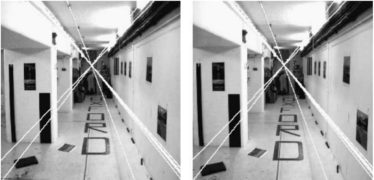
Abbildung 8.18: Beispiel 4: Korridor; Epipole liegen in den Bildern; Punktkoordinaten sind sehr genau bekannt
