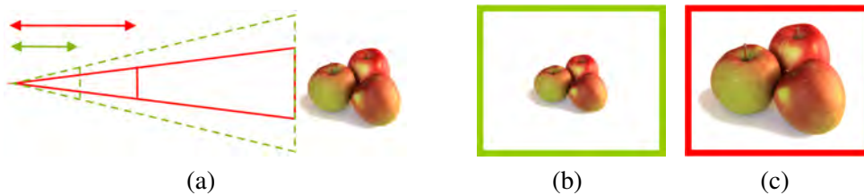
Abbildung 5.33: Verdeutlichung des Zusammenhangs zwischen der Brennweite und dem Zoom-Effekt (Vergrößerung). In (a) wird im zweidimensionalen Fall der Blickwinkel für eine kleine (grün) und eine große Brennweite (rot) dargestellt. Die resultierende Szene, hier aus Äpfeln bestehend, erscheinen im Kamerabild (b) entsprechend klein und in (c) entsprechend groß.
