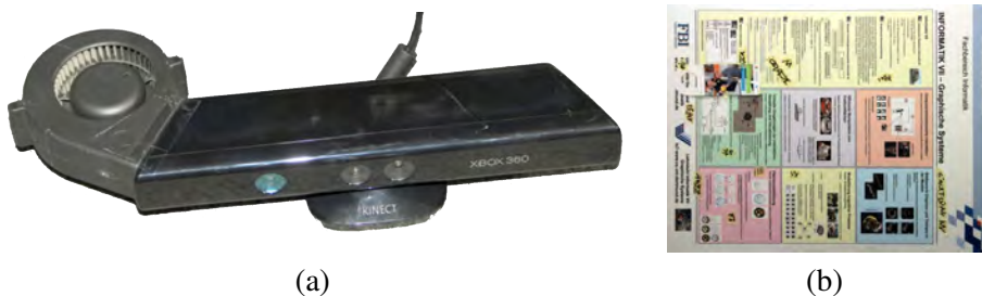
Abbildung 5.30: Die Kinect mit dem extern montierten Radiallüfter (links), der beliebig aktiviert werden kann (a). Im aktivierten Zustand strömt die Luft durch das Kinect-Gehäuse und kühlt dadurch die internen Komponenten ab. In (b) ist das bei den bildbasierten Experimenten verwendete texturreiche Poster abgebildet.
