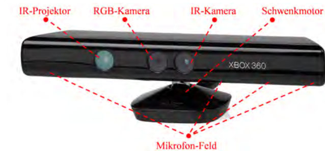
Abbildung 4.8: Die Microsoft Kinect mit den wichtigsten internen Komponenten. Der Abstand zwischen IR-Kamera und Projektor beträgt etwa 7.5 cm, zwischen IR-Kamera und RGB-Kamera etwa 2.5 cm. Neben den optischen Sensoren besitzt die Kinect ein Mikrofon-Feld aus 4 Mikrofonen und einen schwenkbaren Standfuß.
