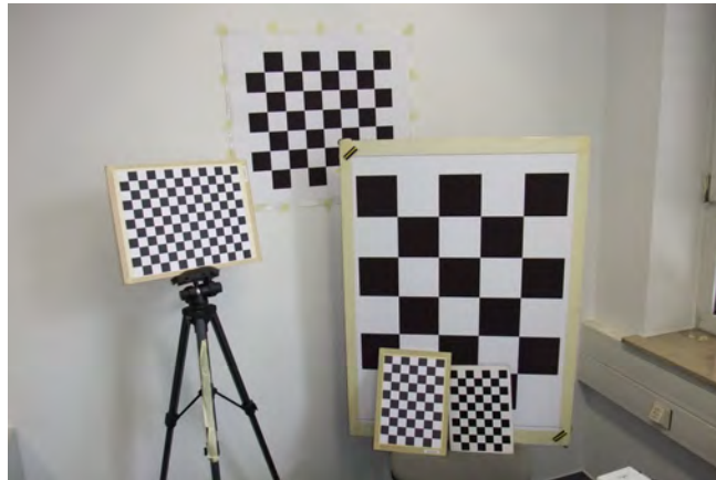
Abbildung 5.18: Gezeigt sind einige der im Rahmen dieser Arbeit entstandenen Kalibrierobjekte. Dabei stellt die Wand eine Erweiterung der planaren Fläche, in der sich das aufgeklebte Schachbrettmuster (oben) befindet, dar.
