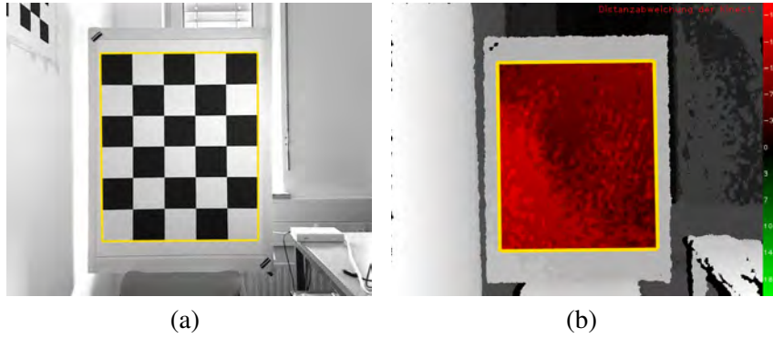
Abbildung 5.24: Das RGB-Bild einer Szene mit dem Kalibrierobjekt ist in (a) und das dazugehörige Tiefenbild der Kinect in (b) dargestellt. Das Tiefenbild ist überlagert mit den farblich dargestellten pixelweisen Abweichungen in Millimetern (siehe Farbskala) zwischen dem Tiefenbild und der Referenzmessung d_{ref} . Nur Pixel innerhalb des relevanten Bereichs, der vollständig zum planaren Kalibrierobjekt gehören muss (durch gelbes Polygon dargestellt), werden ausgewertet.
