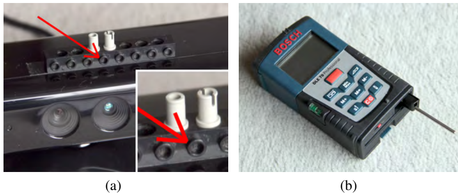
Abbildung 5.25: Die online berechneten Referenzdaten sollen ausgehend von einem fixen Referenzmesspunkt (Rasterloch oberhalb der IR-Kamera, siehe roter Pfeil in (a)) mit Hilfe eines Laser-Distanzmessgerätes (b) verifiziert werden.
